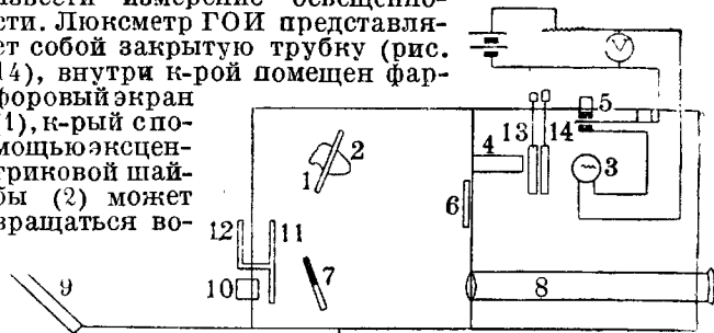
Рис. 14. Люксметр Гос. оптического ин-та (схематический чертеж).
